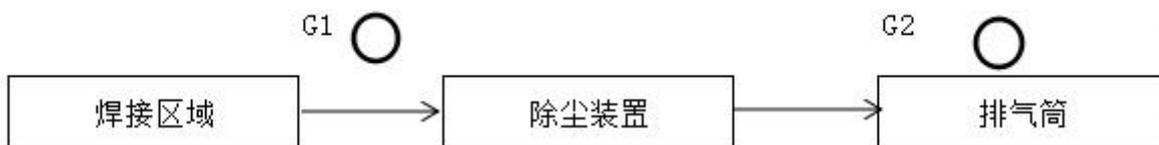
图 5 有组织废气监测点位示意图
