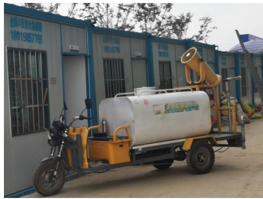
施工场地洒水车
